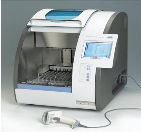
sistema de extracción basado en el uso de partículas magnéticas que permite el aislamiento rápido y automatizado de ácidos nucleicos.
